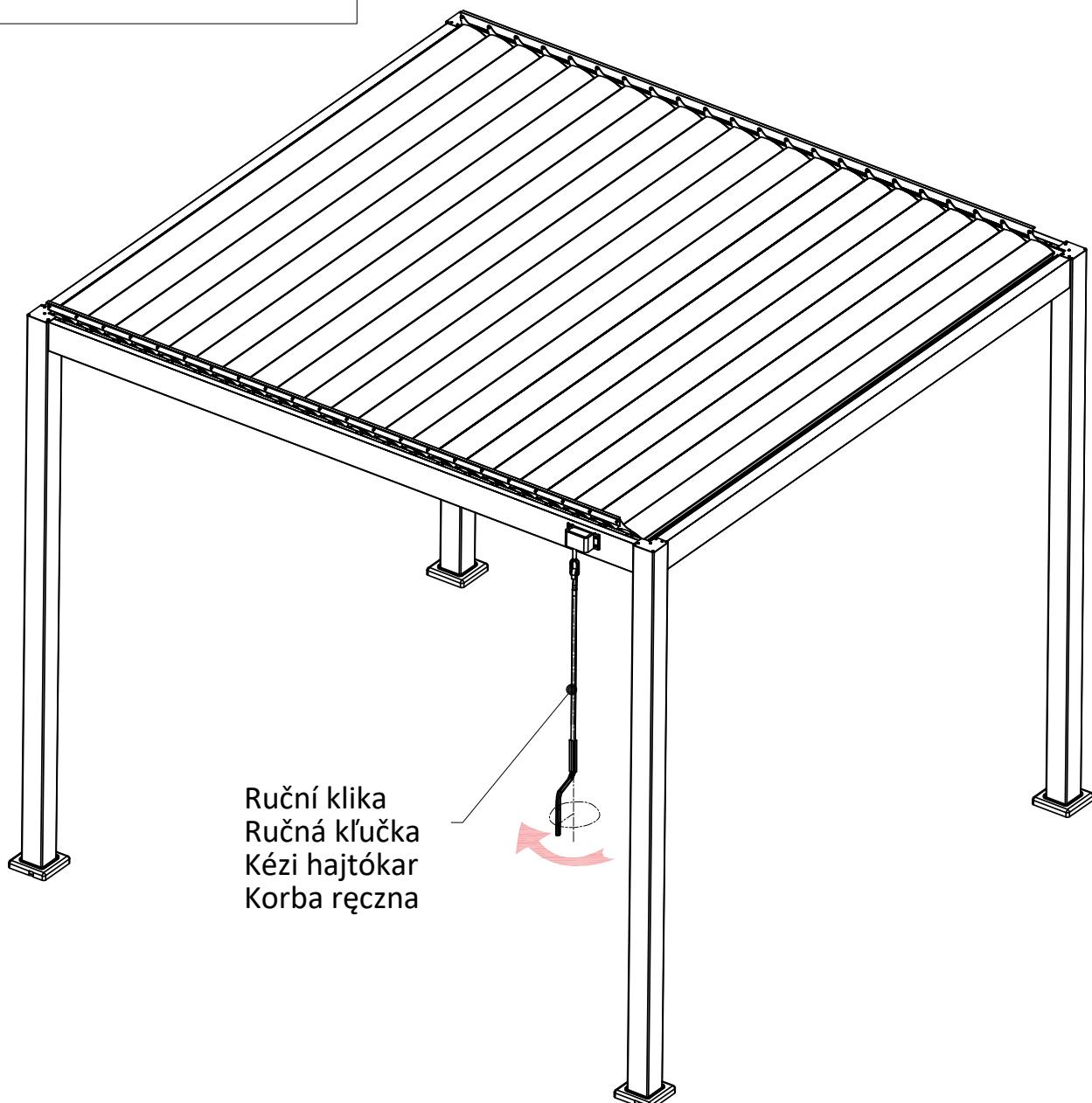
**CZ - LAMELY V ZIMĚ NECHTE OTEVŘENÉ, NA STŘEŠE SE NESMÍ HROMADIT SNÍH,** Odstraňte průběžně ze střechy listí, sníh a jiné nečistoty. Je nutné udržovat mechanismus lamel v čistotě, aby nedošlo k jeho poškození. Na jaře a na podzim kontrolujte pevnost utažení všech šroubů.
