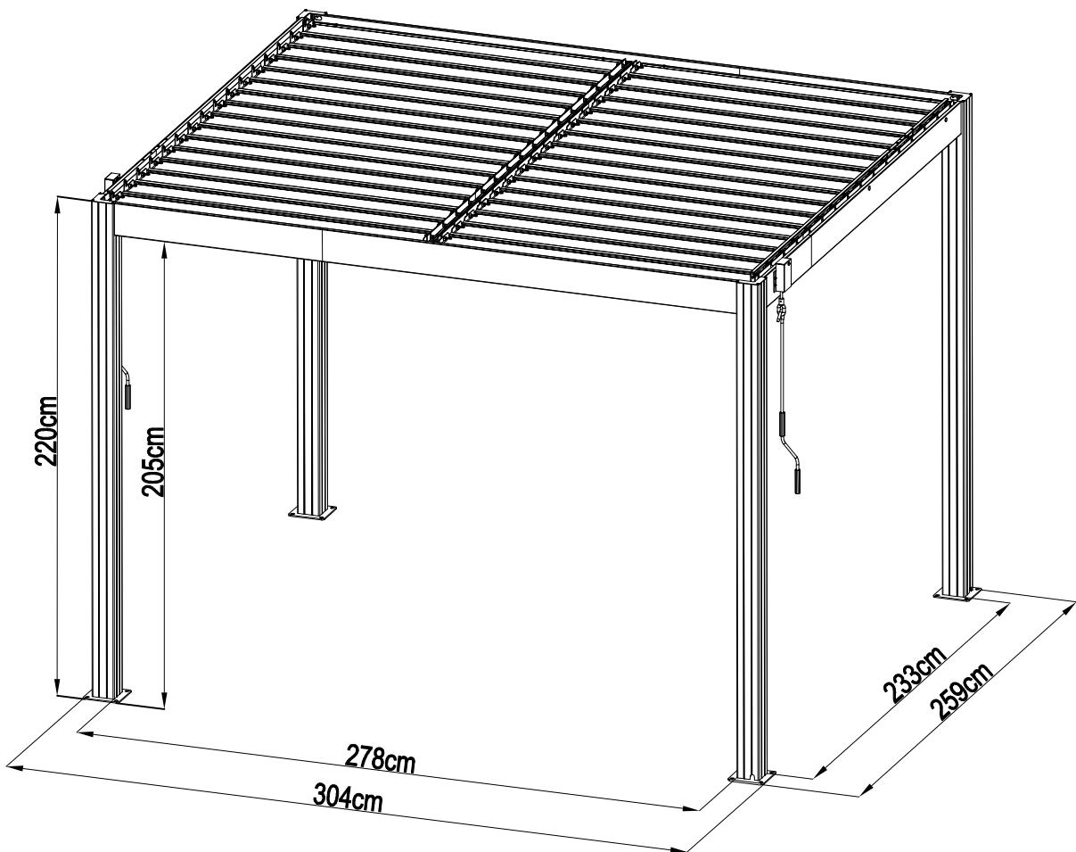
CZ - Pokud nestavíte pergolu na betonové desce, je potřeba pod každým sloupkem odlít betonovou kostku o rozměrech 30x30x30cm, do které bude sloupek následně ukotven.
