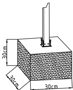
CZ - Pokud nestavíte pergolu na betonové desce, je potřeba pod každým sloupkem odlít betonovou kostku o rozměrech 30x30x30cm, do které bude sloupek následně ukotven.
